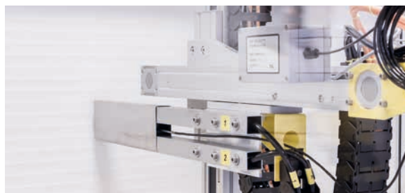
Schwebstofffilterelement während des Scan-Tests
