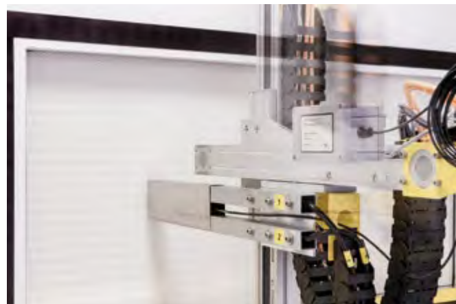
Schwebstofffilterelement während des Scantests
