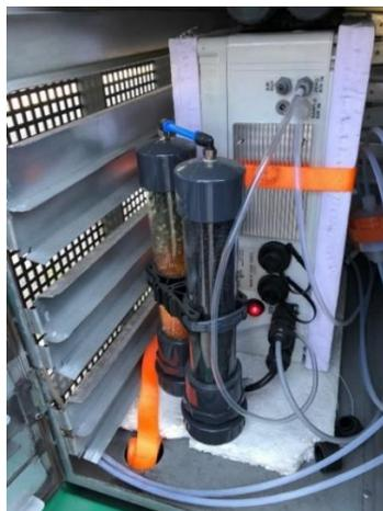
Abbildung 5.3 – In-situ Messung der NO<sub>2</sub>-Adsorptionseffizienz. Messgerät Airyx ICAD verbaut in einer Filtersäule (Phase III)
