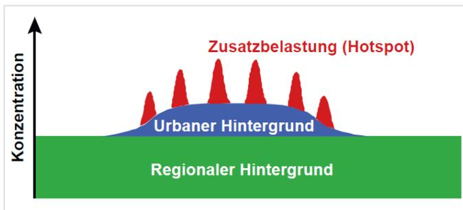
Abbildung 1.1 - Schematische Darstellung der Hintergrund- und Zusatzbelastung (Lenschow et al., 2001; LUBW 2015)
