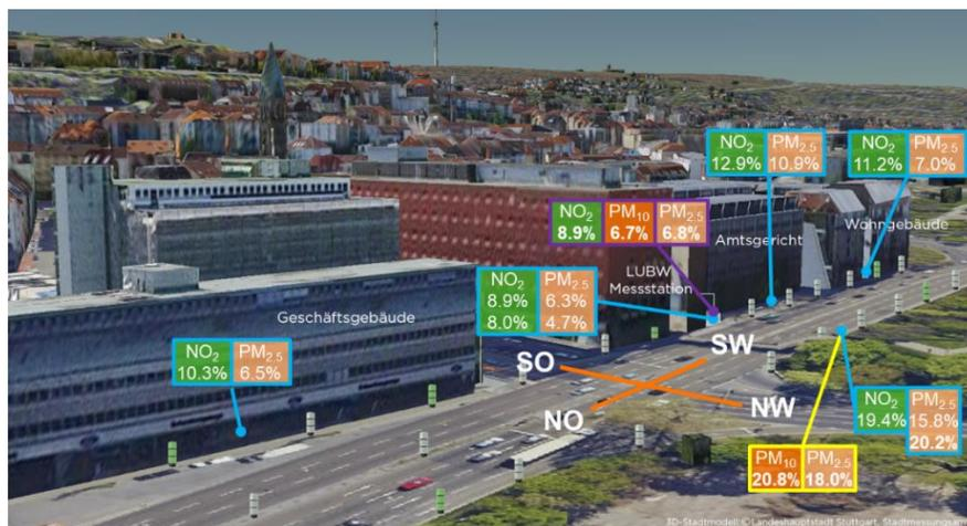
Abbildung 6.2 – Minderungswirkung an den verschiedenen Messpunkten für die 2. halbe Stunde jedes Schaltintervalls. Lila: LUBW; Gelb: Palas Fidas 200s; Blau: Födisch FDS18/GSA19
