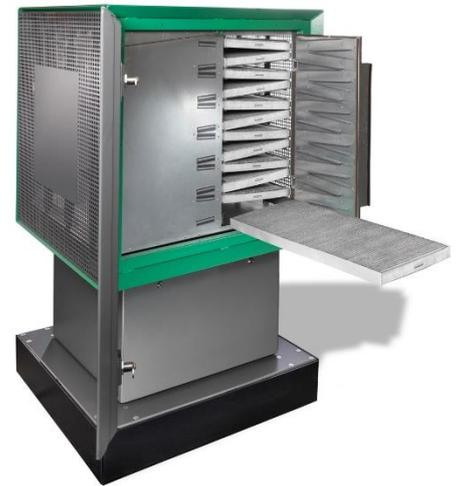
Um der kombinierten Funktion Rechnung zu tragen, wurden die Filter Cubes technisch optimiert, indem der Luftvolumenstrom von  $10.000 \text{ m}^3/\text{h}$  auf  $15.000 \text{ m}^3/\text{h}$  erhöht und die Filterfläche um das dreieinhalbfache vergrößert wurde.
